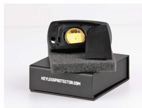
BMW Type 1 KP24-KE01-SCM Montage instructie Batterij CR2450 Adhesive sponge 2*1mm
